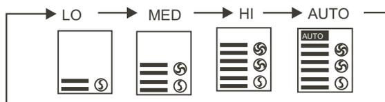
Кондиционер автоматически включит выбранную скорость вентилятора.
