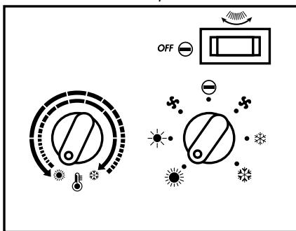
Служит для выбора функций. Вращая переключатель, устанавливают указатель на нужную функцию.
