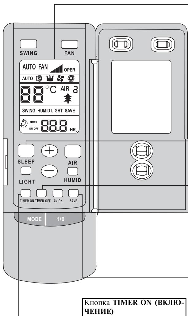
Жидкокристаллический дисплей. На нем отображаются все установленные значения.
