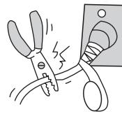
**Не применяйте удлинителей силовых линий и не используйте розетку для одновременного питания другой электрической аппаратуры.**
